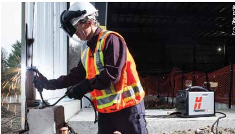
De acordo com Romero, essa alta potência em relação ao peso de apenas 13,5 kg deve-se a uma série de avanços de engenharia do projeto do Powermax30® AIR, caso do novo design do consumível – patente já requerida – que otimiza o fluxo de ar oriundo do compressor interno. "Para o usuário final, isso significa mais eficiência do sistema e performance constante do corte."
