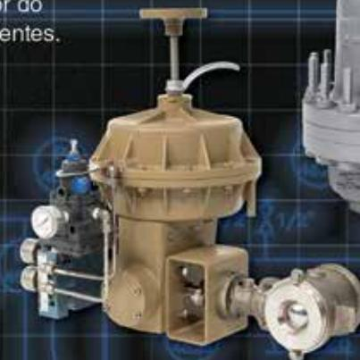
A Ranger QCT dispõe de Mudança Rápida de Guarnição que permite a utilização de vários retentores de vedação e acessórios para variar o tamanho do orifício e ajuda a controlar a cavitação.
